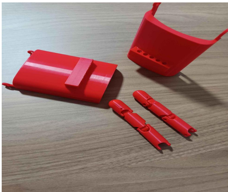
Figura 4 – Protótipo de mão protética produzido em PLA por impressão 3D.
